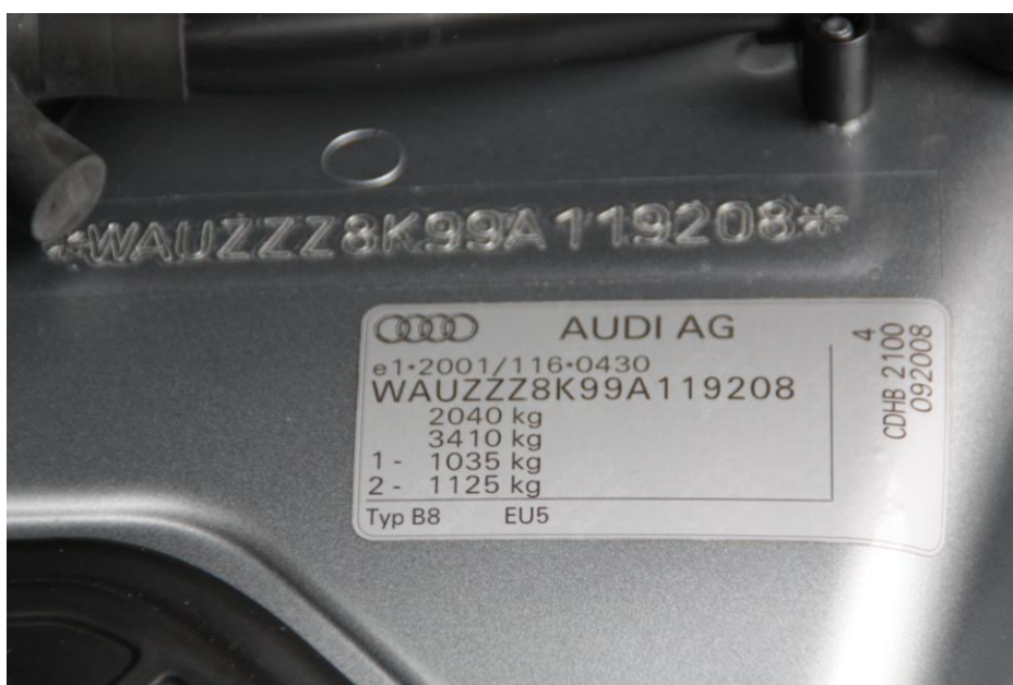
Slika 6: Primer identifikacijske nalepke, za vozilo znamke AUDI
