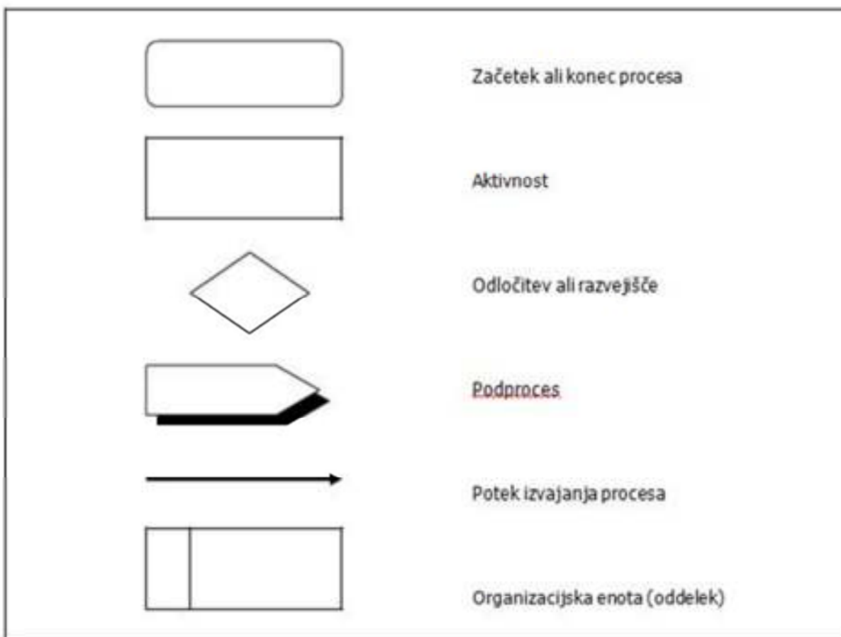
Slika 1: Simboli za modeliranje procesov s tehniko procesnih diagramov
