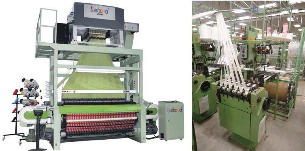
Slika 3: Statve z žakarskim mehanizmom za tkanje etiket (levo) (7) in trakotkalske statve z iglo za tkanje etiket (desno) (8)
