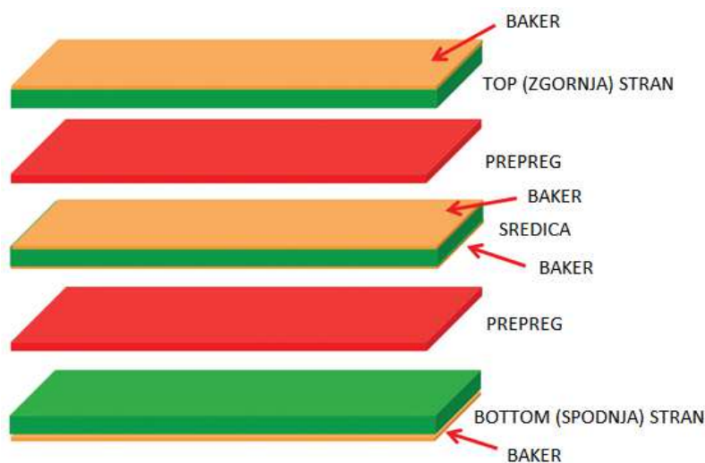
Slika 18: 3D struktura 4-slojnega vezja [11]
