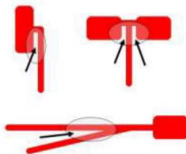
Slika 20: Primeri "acid trapov" [12]
