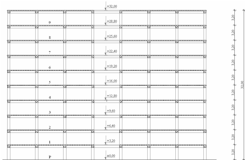
Slika 12: Okvir H3, dispozicija gred in stebrov, skeletna konstrukcija Fig. 12: Frame H3, disposition of analysed beams and columns, frame construction
