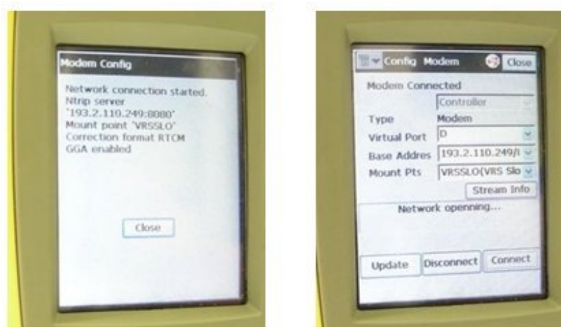
Slika 14: Primer Ntrip odjemalca na kontrolni enoti premičnega sprejemnika
