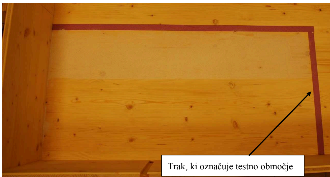
Primer preskusne plošče namesto T-ja
