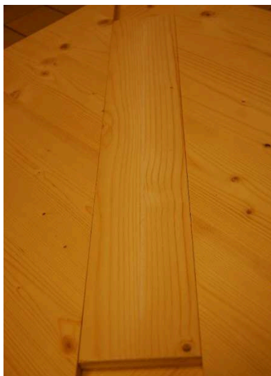
Slika 5: Preskusna plošča z vložkom z razpoko
