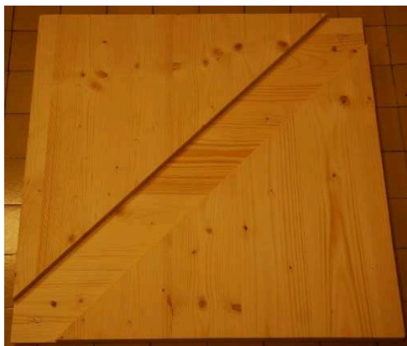
Slika 6: Preskusna plošča z odstranjenim vložkom z razpoko
