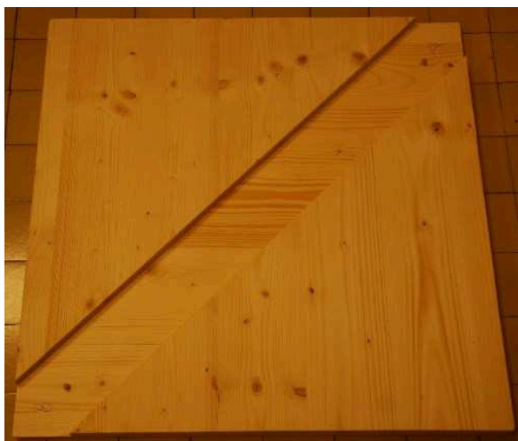
Primer preskusne plošče z odstranjenim vložkom z razpoko
