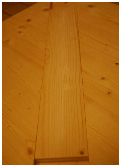
Primer preskusne plošče z razpoko z vložkom
