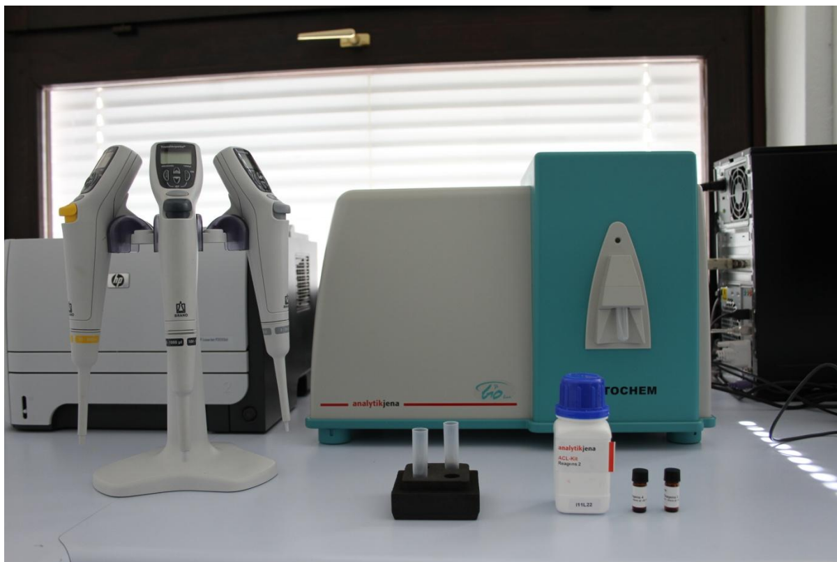
Slika 6: Aparat Photochem, avtomatske pipete in pripravljene reagenti, ki jih potrebujemo za določitev antioksidativne kapacitete
