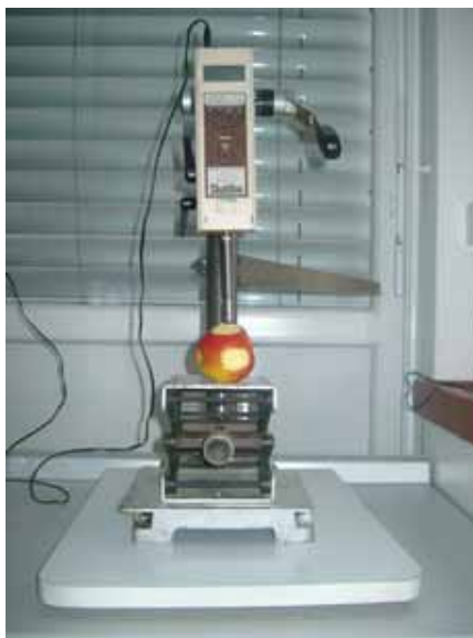
Slika 7: Fotografija penetrometra Chatillion Digital force gage dfg – 50 (foto: Urh, 2006)
