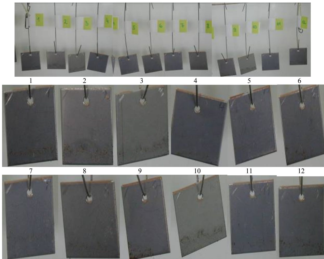
Slika 17: Neobdelana površina ploščic (večji dodatek manoproteinov 1; 1,0 g/L) po poskusu
