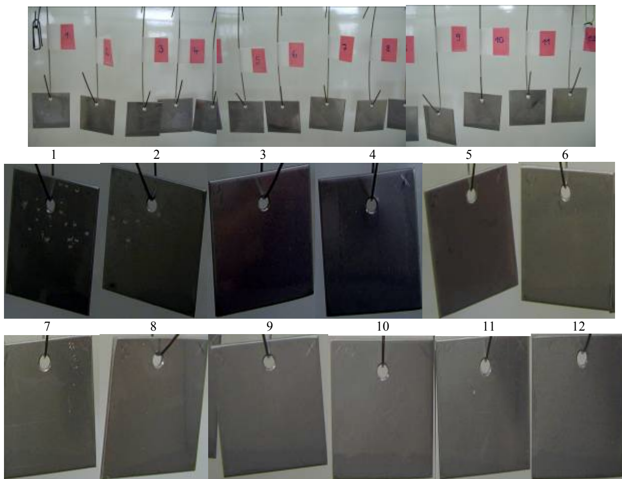
Slika 13: Neobdelana površina ploščic po poskusu
