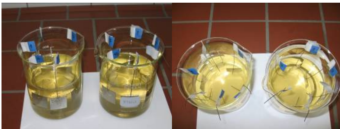
Slika 8: Nastavitev poskusa – 1000 mL merilne čaše, volumen vina v čaši je 700 mL
