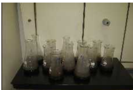
Slika 9: Segrevanje vzorcev sira, srebrovega nitrata in dušikove kisline do vrenja ter dodatek kalijevega permanganata
