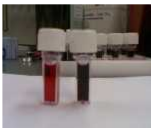
Slika 13: Kiveta z naprej pripravljenim reagentom R1 pred inkubacijo (desno), kiveta z reagentom R1 in vzorcem po inkubaciji (levo). Rezultat je sprememba barve
