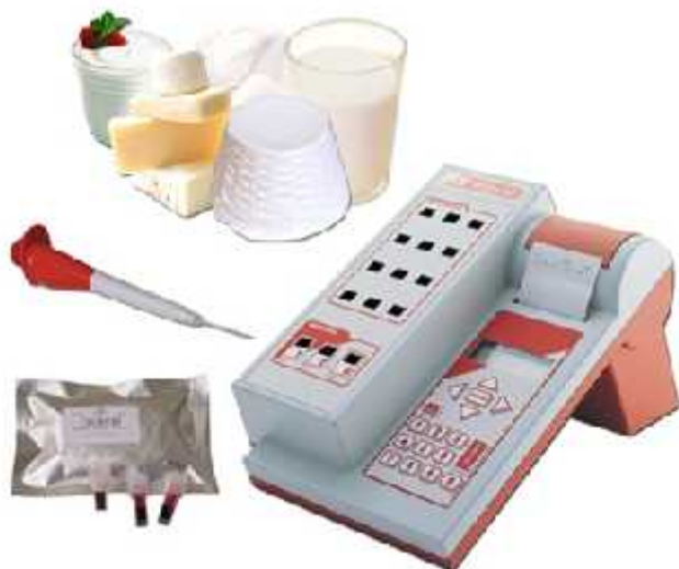
Slika 1: Slika sistema FOODLAB (aparatus, komplet kivet in priložena pipeta) (GROSSERON, 2012)
