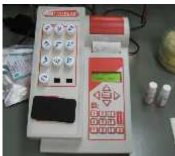
Slika 6: Kivete z reagenti na inkubaciji za določanje vsebnosti kloridov v siru
