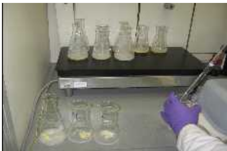
Slika 8: Segrevanje vzorcev sira v mešanici srebrovega nitrata ter dušikove kisline
