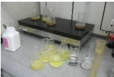
Slika 10: Odstranitev presežka permanganata z dodatkom glukoze in razreditev z destilirano vodo
