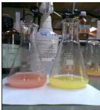
Slika 14: Vzorec surovega masla po titraciji (rožnata barva) in pred titracijo (rumena barva)
