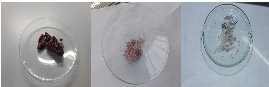
Slika 6: Neprekristaliziran vzorec vinskega kamna rdečega vina – levo, vzorec po navadni prekristalizaciji – v sredini in vzorec po prekristalizaciji z aktivnim ogljem – desno.
