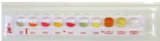
Slika 12: Test Api NH za identifikacijo bakterij iz rodov Neisseria , Haemophilus in Moraxella (BioMerieux, 2011)
