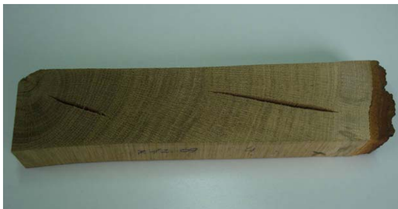
Slika 37: Pojav kolapsa (vzvalovana površina) in notranjih satastih razpok na sledilnih vzorcih po 39 dneh sušenja (Gorišek in sod., 2010).
