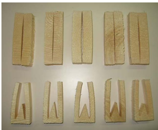
Slika 22: Preizkušanci za določanje sušilnih napetosti pri smrekovini: zgoraj – po prežagovalni metodi in spodaj – po metodi vilic.
