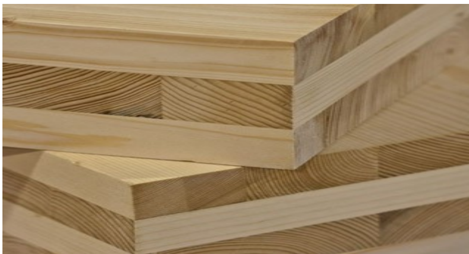
Slika 4: Primer trislojne križno lepljene plošče
