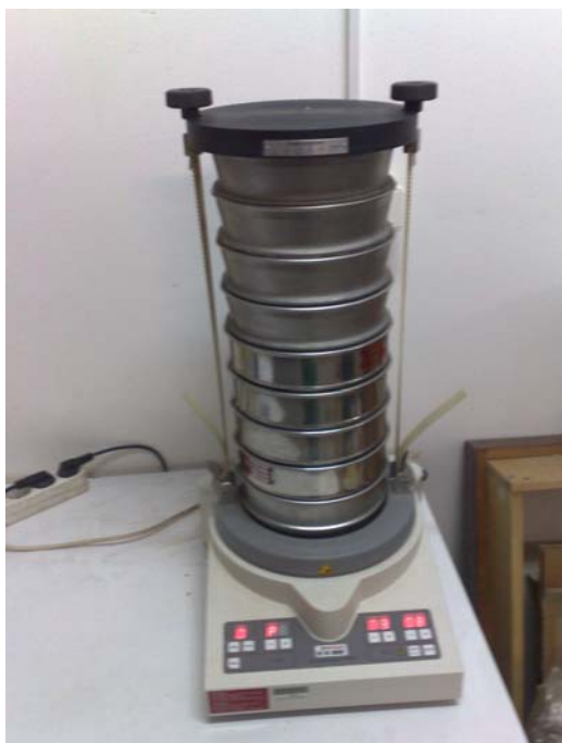
Slika 19: Stresalna naprava s siti za ugotavljanje velikosti lesnih sekancev
