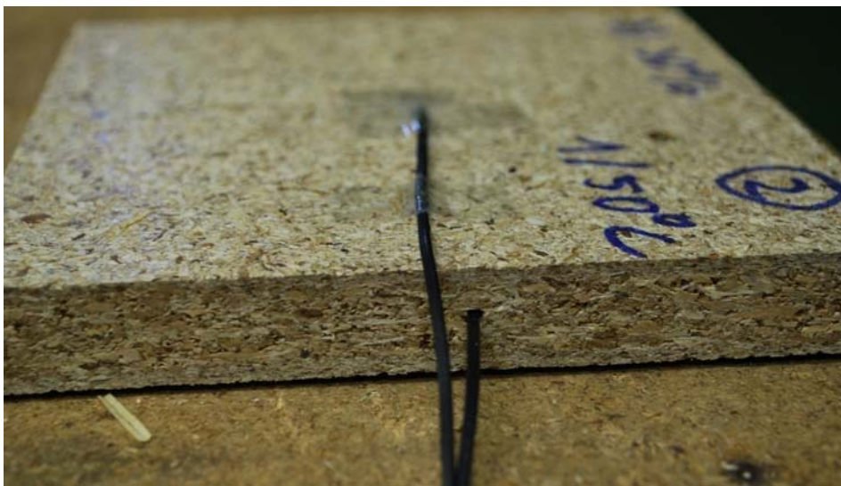
Slika 2: Prikaz pozicije termočlenov v plošči
