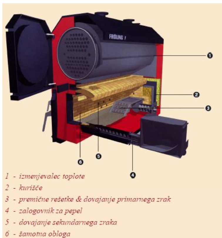
Slika 9: Prikaz kurilne naprave z kuriščem pod kotlom (Froling, 2000)
