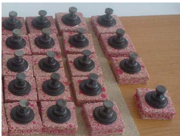
Slika 6: Pripravljene vzorci za preizkus zlepljenosti
