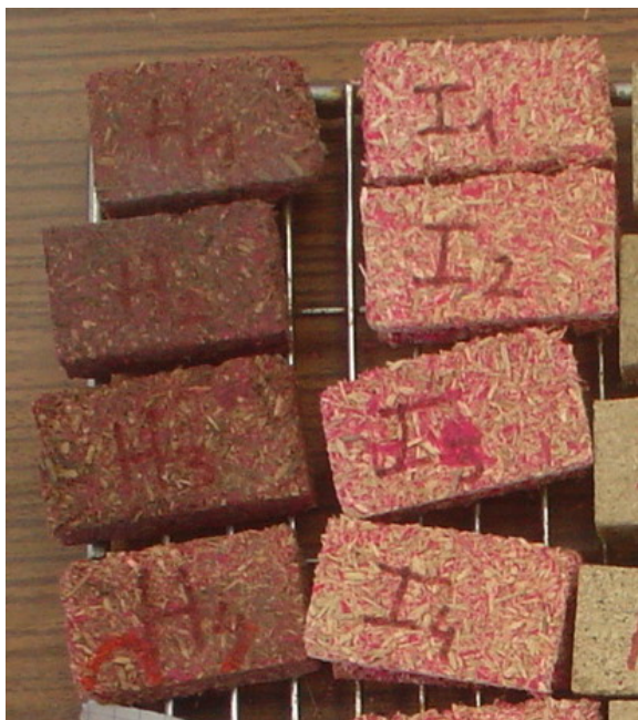
Slika 3: Vzorci, ki smo jih uporabili pri določanju izgube mase zaradi delovanja gliv razkrojevalk.
