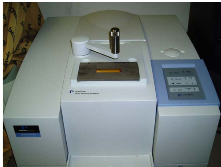
Slika 5: Inštrument Spectrum one za merjenje nihajnih spektrov lesa FTIR
