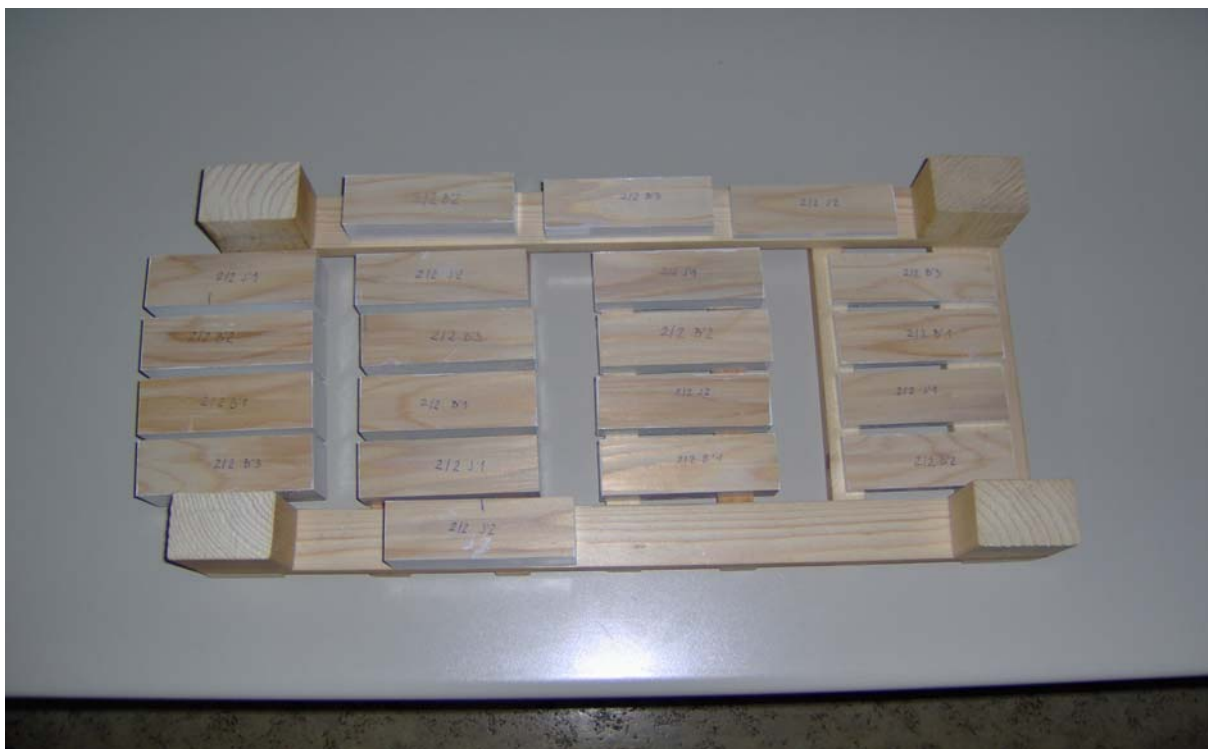
Slika 3.2: Vzorci beljave in jedrovine jelovine, pripravljene za merjenje difuzivnosti pri nestacionarnih pogojih.
