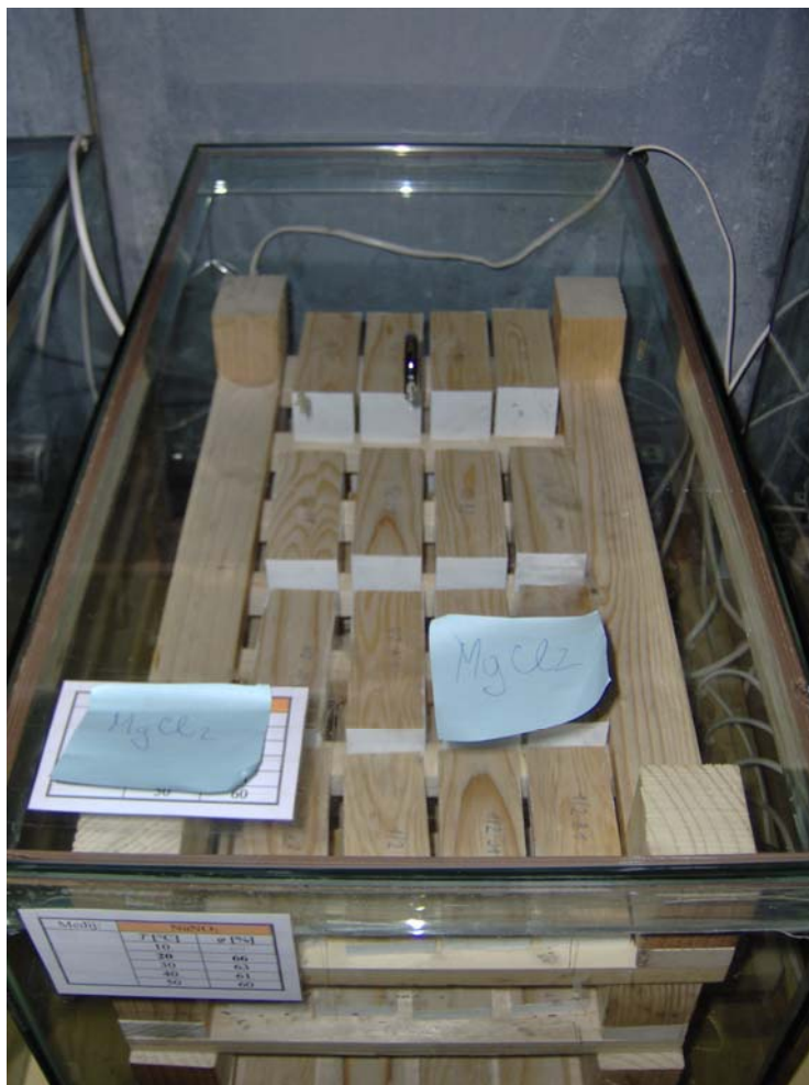
Slika 3.5: Merjenje difuzivnosti pri nestacionarnih pogojih: vzorci v zatesnjeni komori s prisilnim gibanjem atmosfere (0,4 m/s) nad nasičeno raztopino magnezijevega klorida (MgCl), pri konstantni temperaturi.
