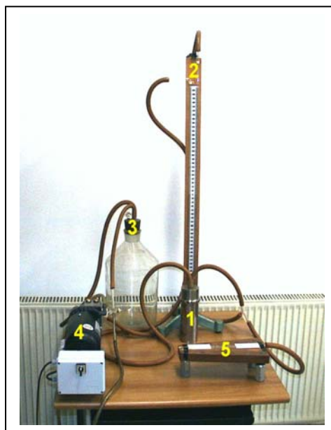
Slika 3.3: Nekoliko modificirana Petti-jeva naprava za merjenje plinske permeabilnosti lesa (laboratorij za sušenje lesa pri Katedri za tehnologijo lesa): 1) merilna celica oz. cilinder, 2) živosrebni manometer, 3) balastna posoda, 4) vakuumska črpalka, 5) umerjena kapilara
