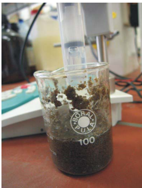
Slika 4: Merjenje pH sistema les - zaščitni pripravek
