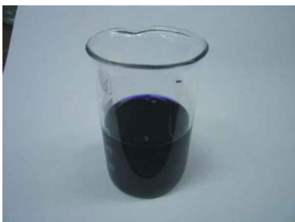
Slika 1: Vzorec zaščitnega pripravka CuE najvišje koncentracije ( c_{Cu} = 0,5 \% )
