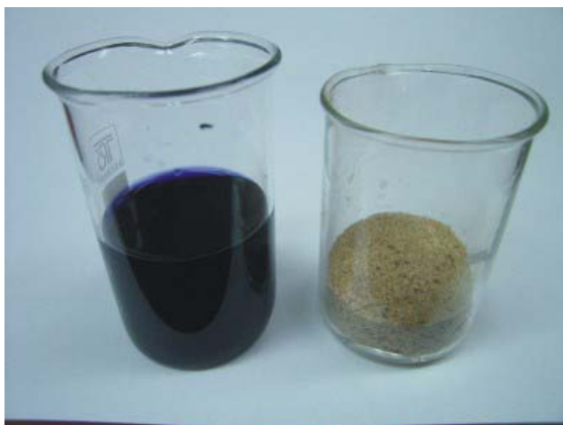
Slika 2: Zaščitni pripravek in vzorec smrekove žagovine pred impregnacijo
