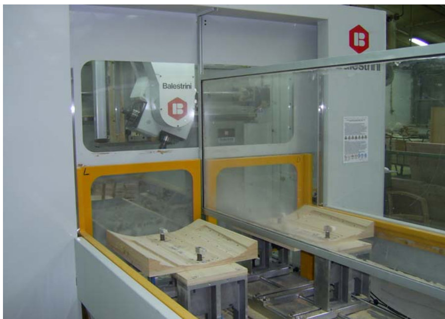
Slika 5: Obdelovalni mizi na CNC-petosnem obdelovalnem stroju, modela IDEA 2
