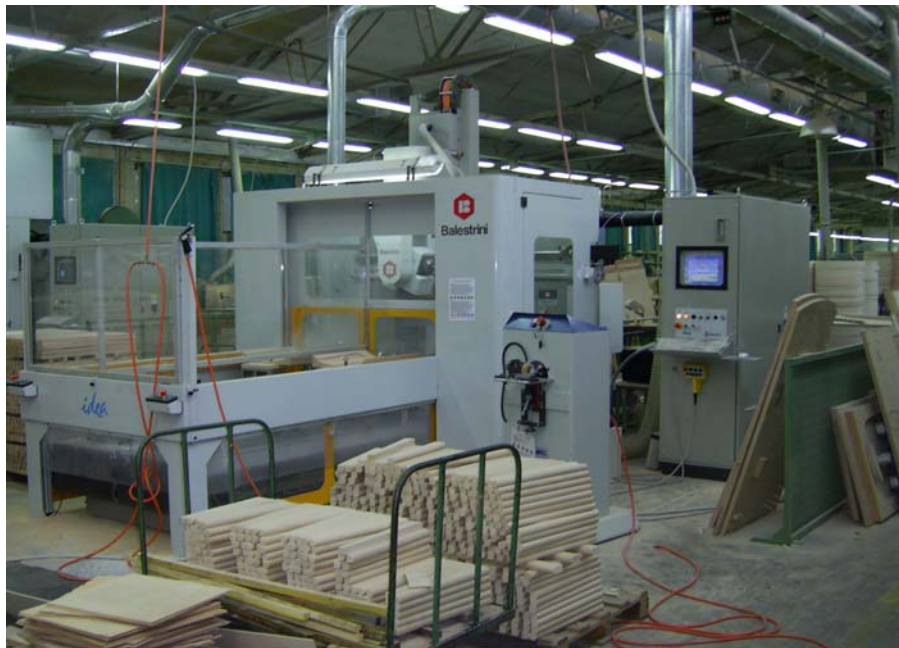
Slika 4: CNC-petosni obdelovalni stroj, model IDEA 2
