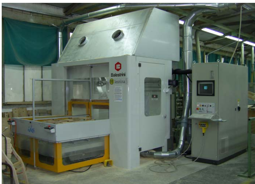
Slika 2: CNC-petosni obdelovalni stroj, model IDEA
