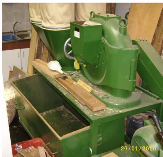
Slika 1: Laboratorijski iverilnik Condux LT 61.
