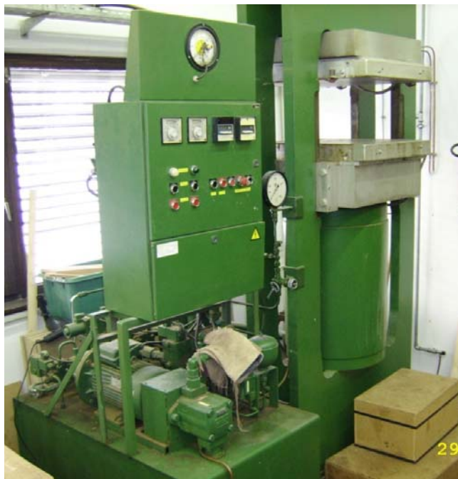
Slika 5: Laboratorijska enoetažna hidravlična stiskalnica LT 63.
