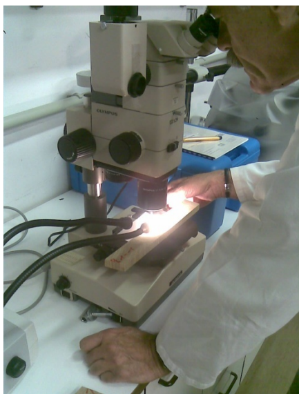
Slika 2: Mikroskopsko določevanje debeline premaznega sistema
