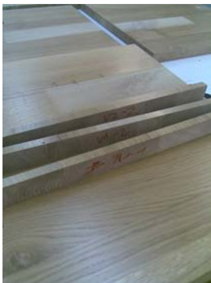
Slika 1: Vzorci za določitev debeline premaznega sistema
