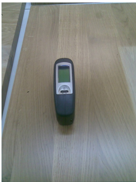
Slika 3: Določevanje sijaja površinskega sistema
