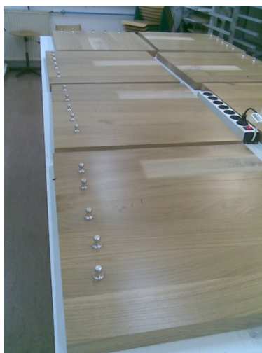
Slika 4: Prilepljeni pečati na površinskem sistemu
