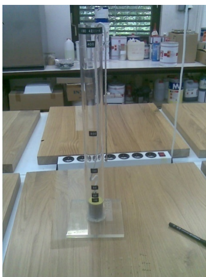
Slika 7: Testiranje odpornosti proti udarcem
