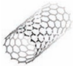
Slika 10: Struktura enostenske ogljikove nanocevke (SWCNT) [27]
