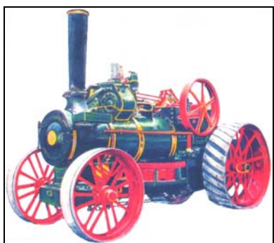
Slika 1 : Lokomobila predstavlja začetek traktorske tehnike (Jejčič, 2007c)
