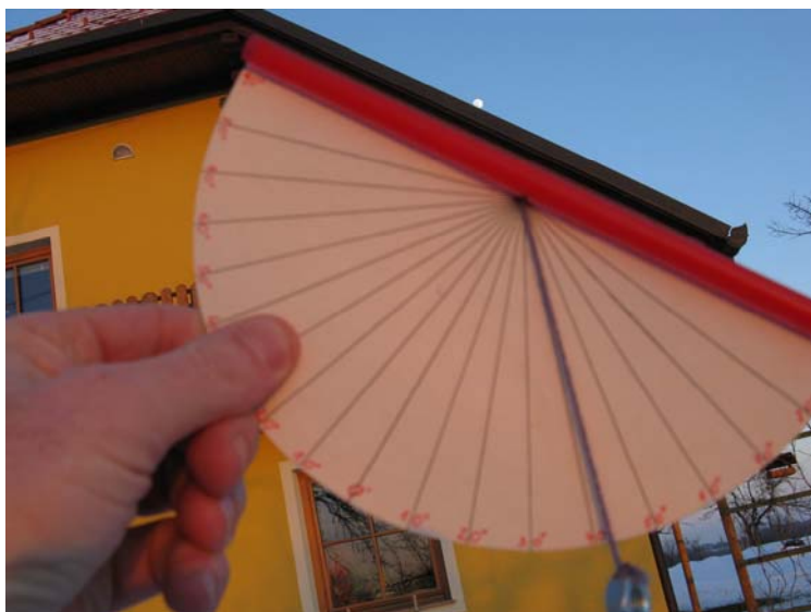
Slika 9: Enostaven instrument za izmero naklona ostrešja (foto: Jakob Ivanuša).
