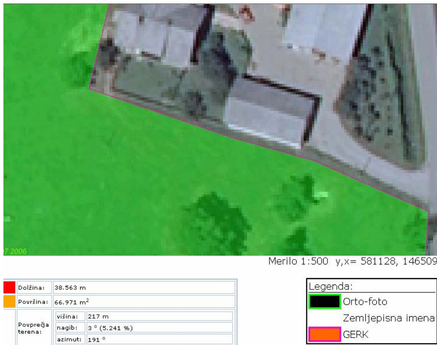
Slika 10: Primer izmere strešne površine usmerjene proti jugu (Ministrstvo za kmetijstvo..., 2009).
