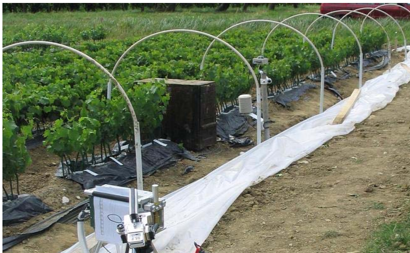
Slika 2: Poskusna parcela s konstrukcijo za zaščito pred padavinami, Slap pri Vipavi 2004 (Kržan K.)
