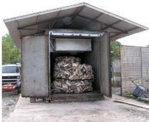
Slika 13: Primer posebne sušilnice za sušenje večje količine lesne biomase (Biomass Energy Centre, 2008).
