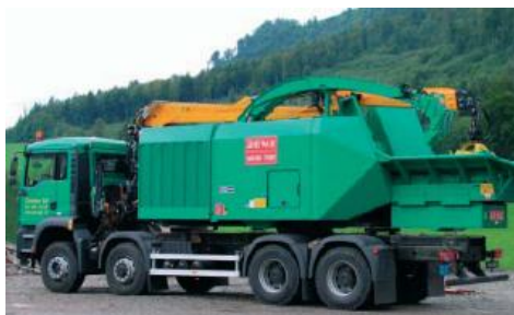
Slika 3: Velik sekalnik na kamionu in z dvigalom proizvajalca Jenz. (Jenz sekalniki 2009)
