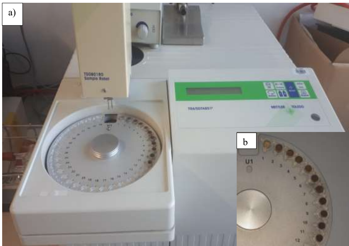
Slika 6: Fotografija termoanalizatorja Metler Toledo TG/SDTA 851 (a) s prikazanimi vzorci lesa (b) pred začetkom meritve. Vzorci so v Pt lončkih nameščeni na avtomatski menjalnik.
