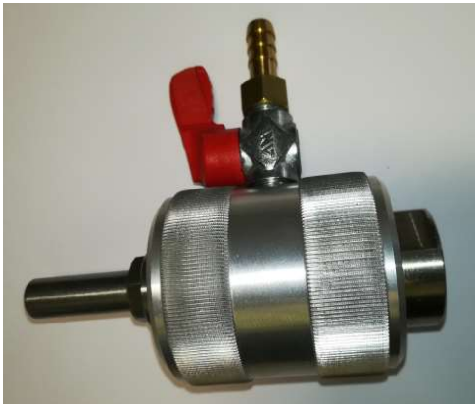
Slika 3-2: Prikluček za dovod hladilnega sredstva
