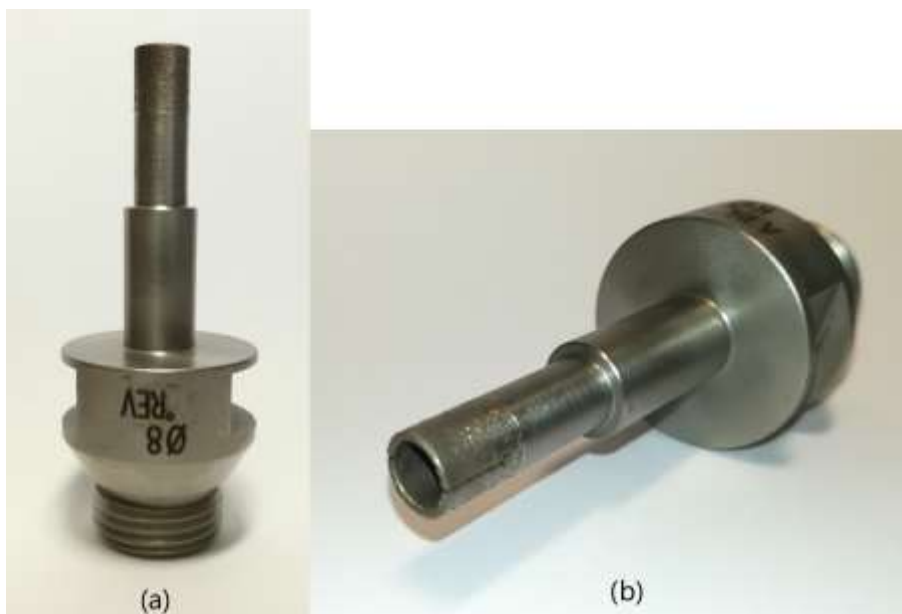
Slika 3-4: (a) Sveder premera 8 mm. (b) Konica svedra s prevleko diamantnih abrazivov
