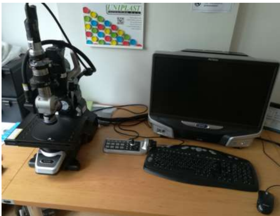
Slika 3-5: Laboratorijska oprema KEYENCE VHX 6000
