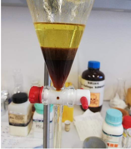
Slika 6: Lij ločnik z vodno, organsko in vmesno želatinasto plastjo
