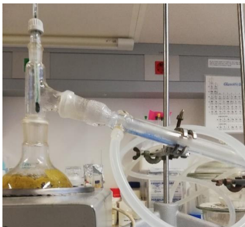
Slika 13: Aparatura uporabljena za destilacijo kamazulena
