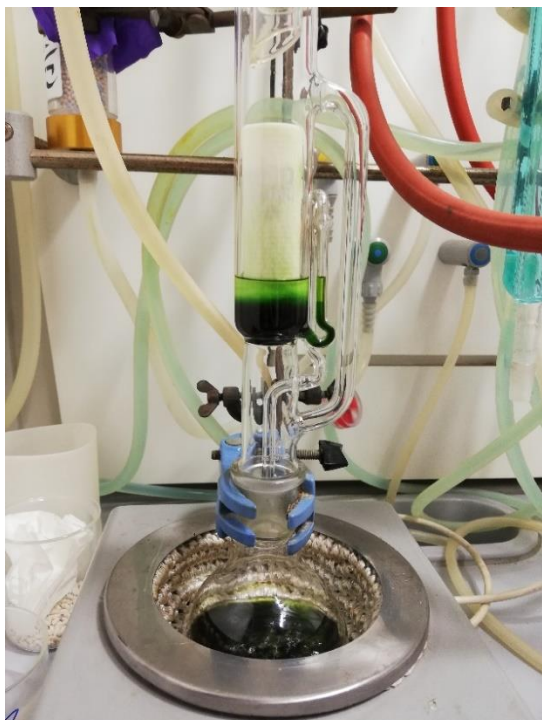
Slika 16: Ekstrakcija industrijske konoplje s Soxhletovim aparatom
