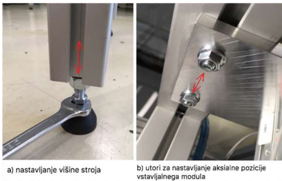
Slika 3.16: Nastavljanje višine stroja in vstavljalnega modula aksialno
