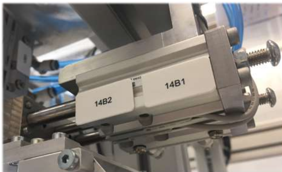
Slika 2.9: Dvosmerni pnevmatski cilinder z dodatnim vodenjem in mehansko zaporo za povratni gib
