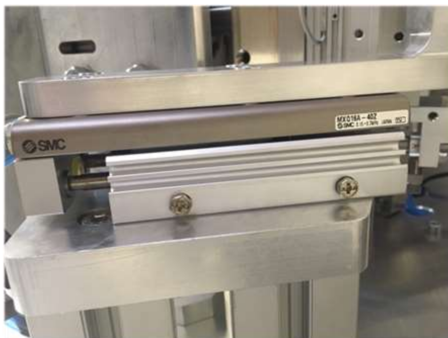
Slika 2.11: Dvosmerni pnevmatski cilinder z dodatnim preciznim vodenjem s krogličnimi vodili
