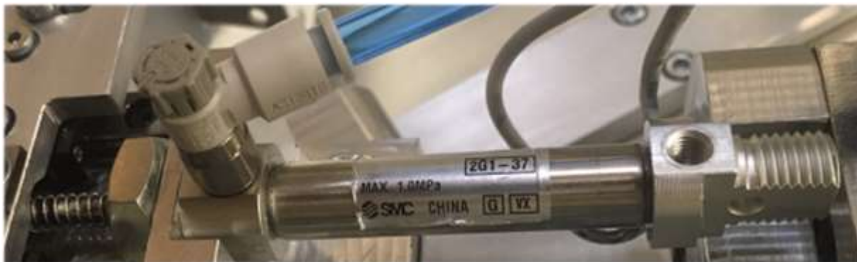
Slika 2.10: Enosmerni pnevmatski cilinder z dodatno vzmetjo za povratni gib
