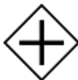
Slika 3.5: Paralelni prehod (Parallel Gateway) [5]
