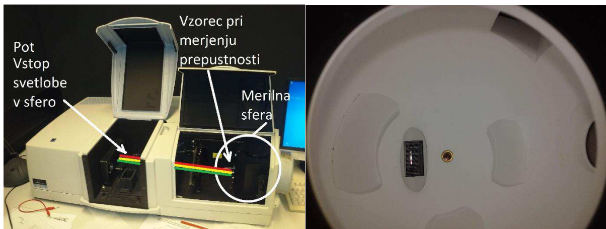
Slika 4.4 Spektrofotometer Perkin Elmer Lambda 950 (levo) in notranjost merilne sfere s senzorjem svetlobe (desno)
