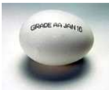
Slika 2.2: Primer kapljičnega tiska na neravni površini [4]
