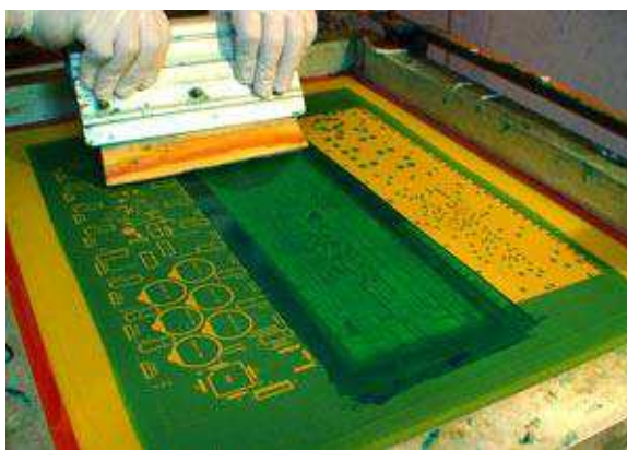
Slika 2.5: Primer treh različnih šablon za nastanek enega vezja [7]
